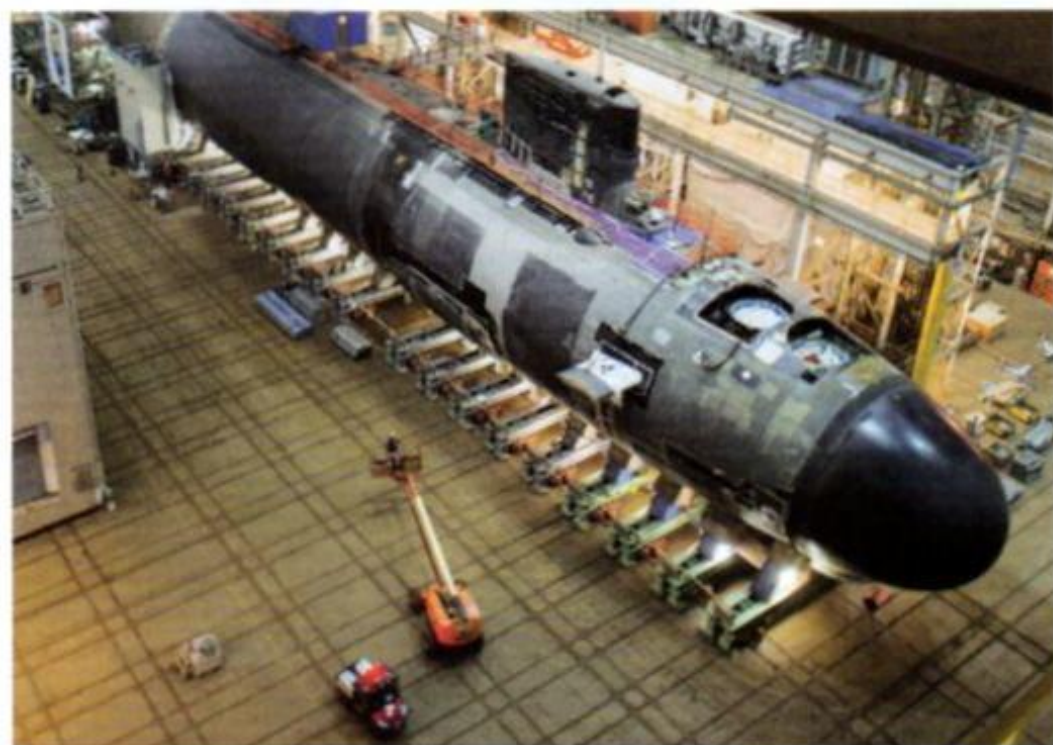
L'ILLINOIS nella fase finale di allestimento nei cantieri di Groton (estate 2015), con i portelloni dei VPT ancora da installare. (foto: HII)
