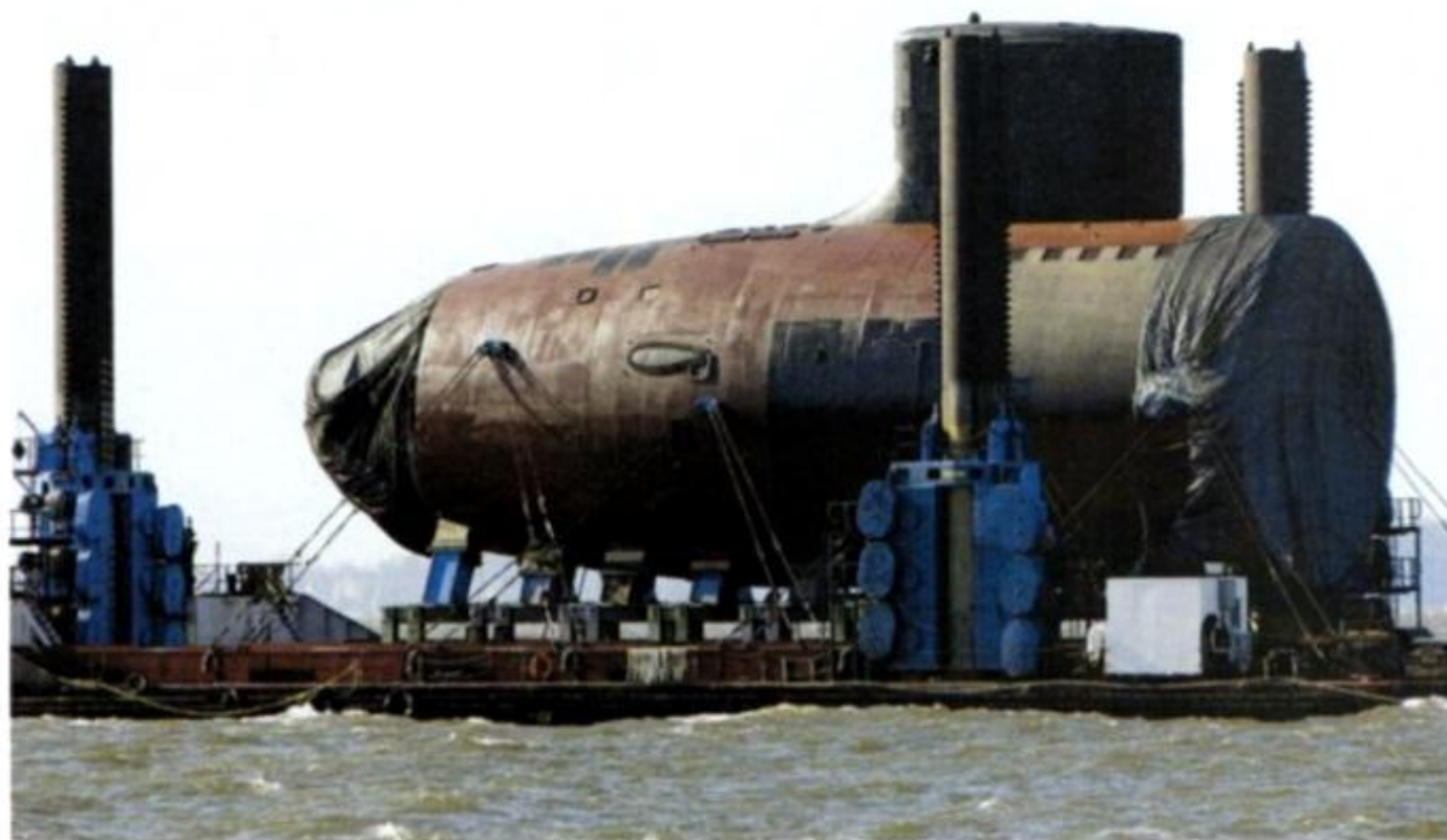
Il modulo prodiero del NEW HAMPSHIRE lascia il cantiere di Newport News verso Groton dove avverrà l'assemblaggio del battello. (foto: HII)
