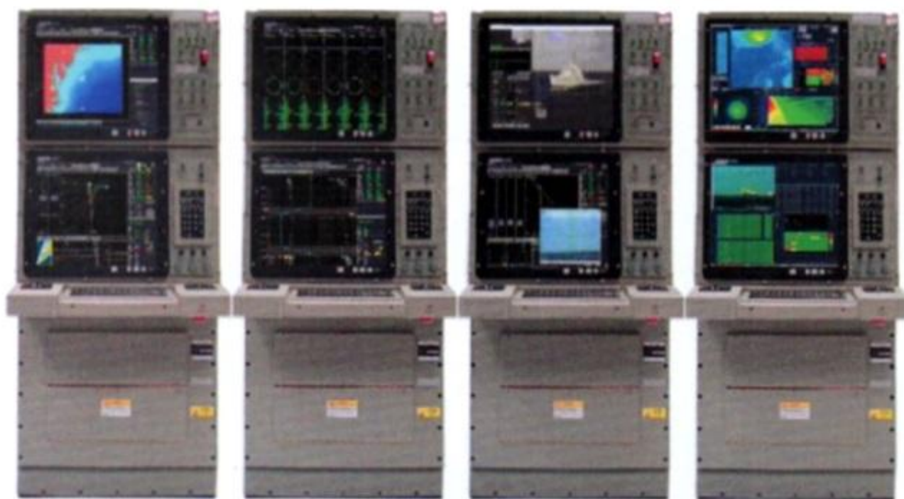
Le 4 consolle di rappresentazione del sistema per la gestione operativa AN/BYG-1 ad architettura multipla e operante attraverso una LAN a ridondanza multipla che fa uso di fibre ottiche. (foto: Raytheon)
