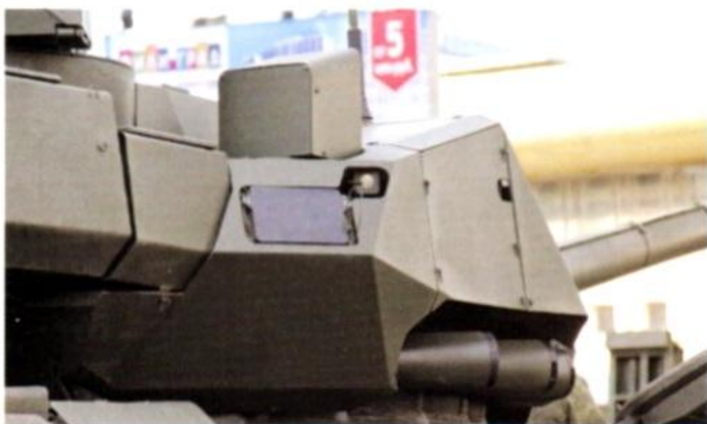
Sopra, a sinistra: un dettaglio di 3/4 dietro del lato destro della torretta che mostra una delle 4 antenne radar con a lato un sensore elettro-ottico e sopra uno dei 2 complessi brandeggiabili del sistema AFGHANIT. La stessa porzione di torretta è ritratta, di lato, sotto. Sopra, a destra, il power pack completo.
