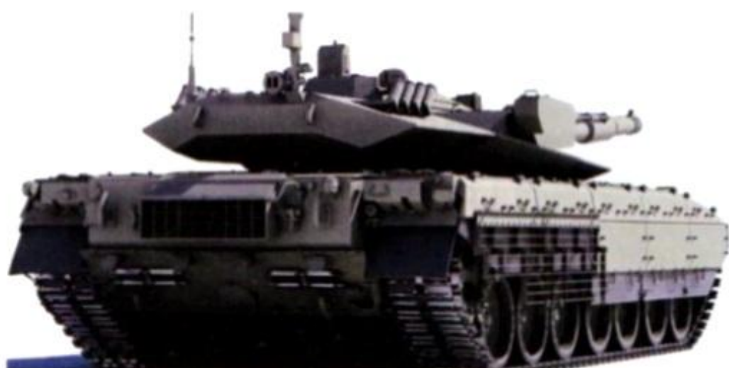
Due immagini del mock-up del T-95. Ai lati della torretta si vede la 2A42 da 30 mm e un'arma a canne rotanti.
