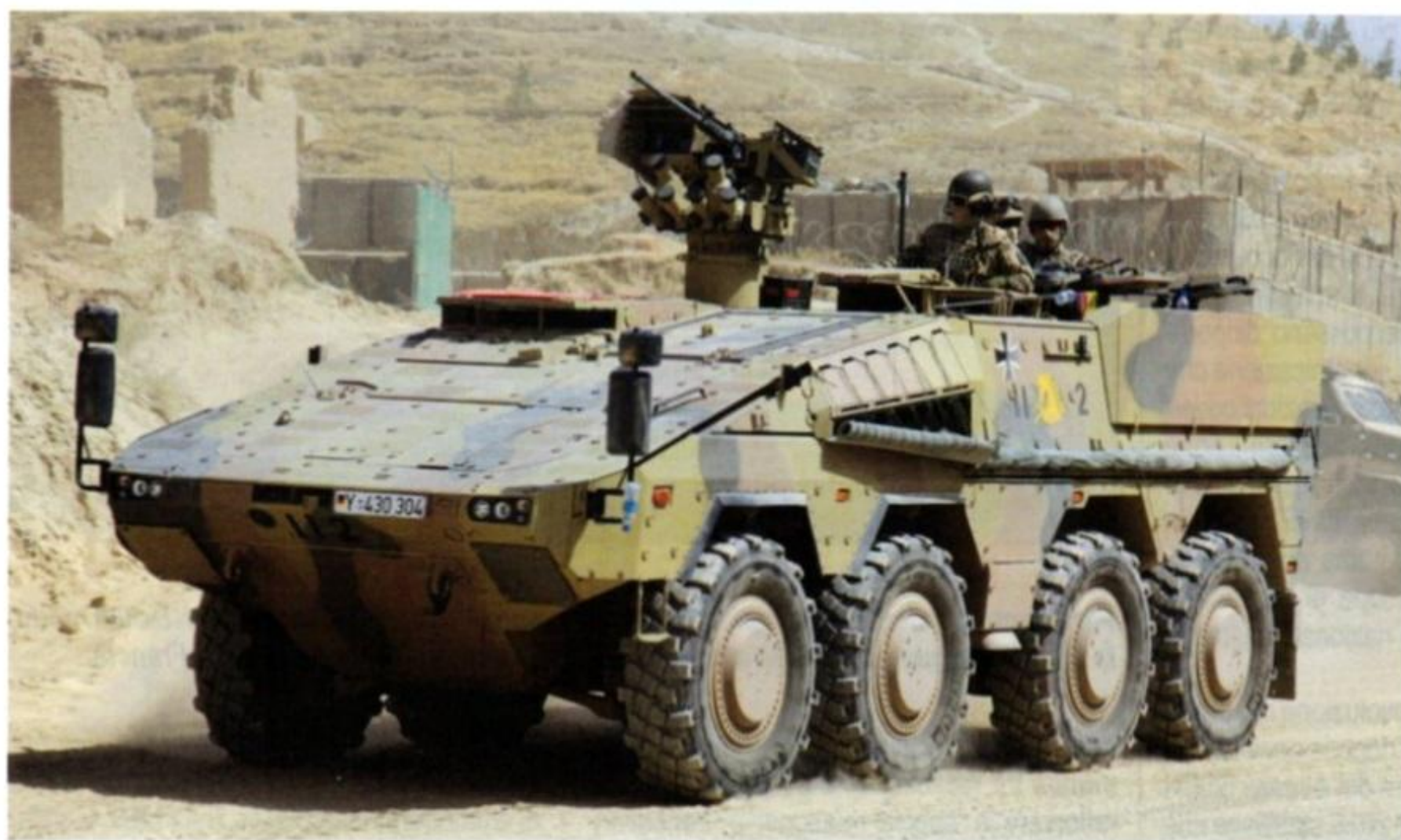
Un 8x8 BOXER A1 in Afghanistan nel corso dell'impiego di questa versione migliorata nel complesso teatro asiatico. Notare la struttura cilindrica sotto alla torretta a comando remoto, una delle migliorie introdotte con la variante A1. (foto: Bundesweher)
