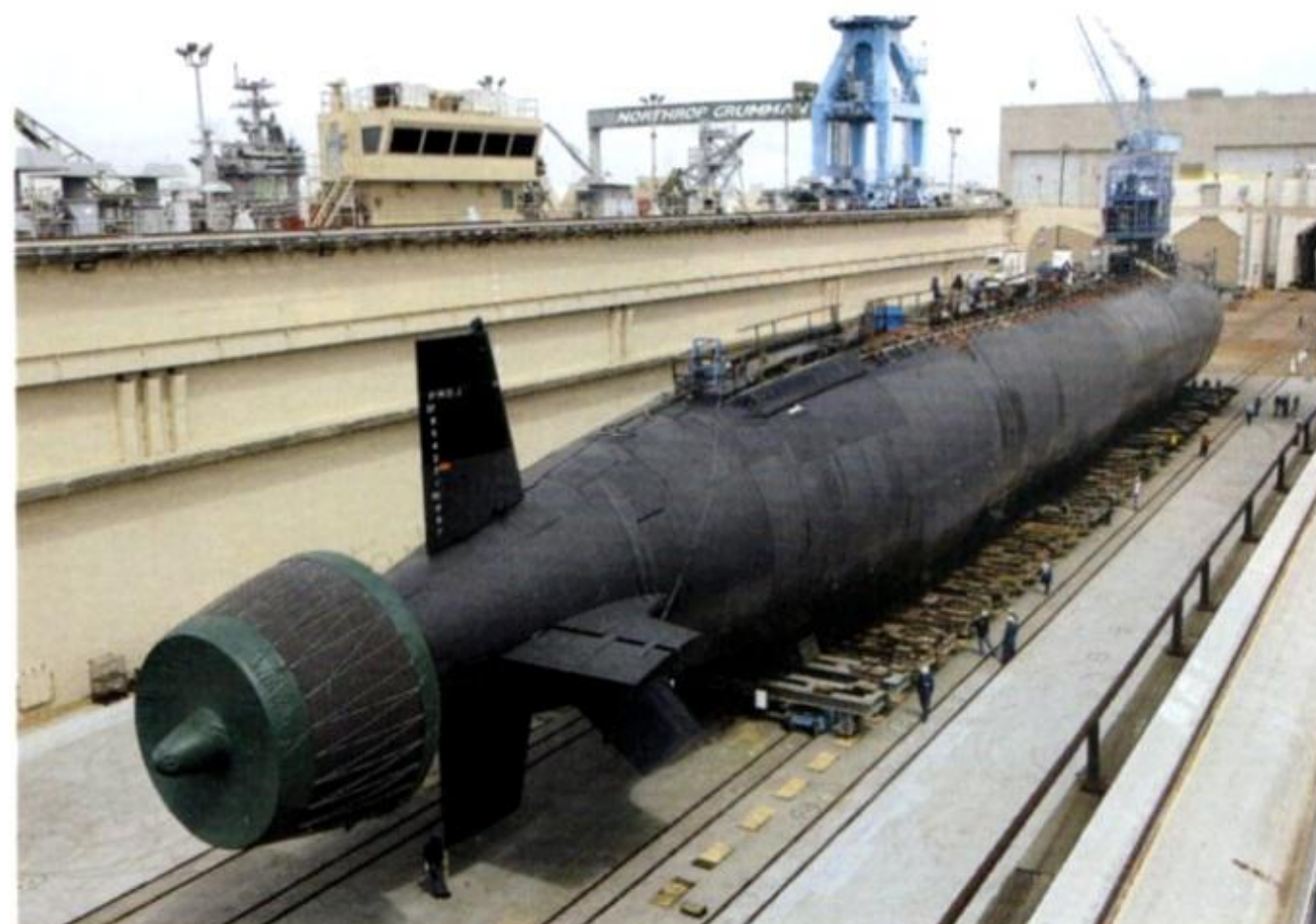
Immagine di poppa dritta del TEXAS sullo scalo prima del varo: si notano il propulsore pump-jet (opportunamente celato), le superfici di governo poppiere e lo stabilizzatore di dritta, inclinato di 45° rispetto all'asse longitudinale del battello. (foto: HII)
