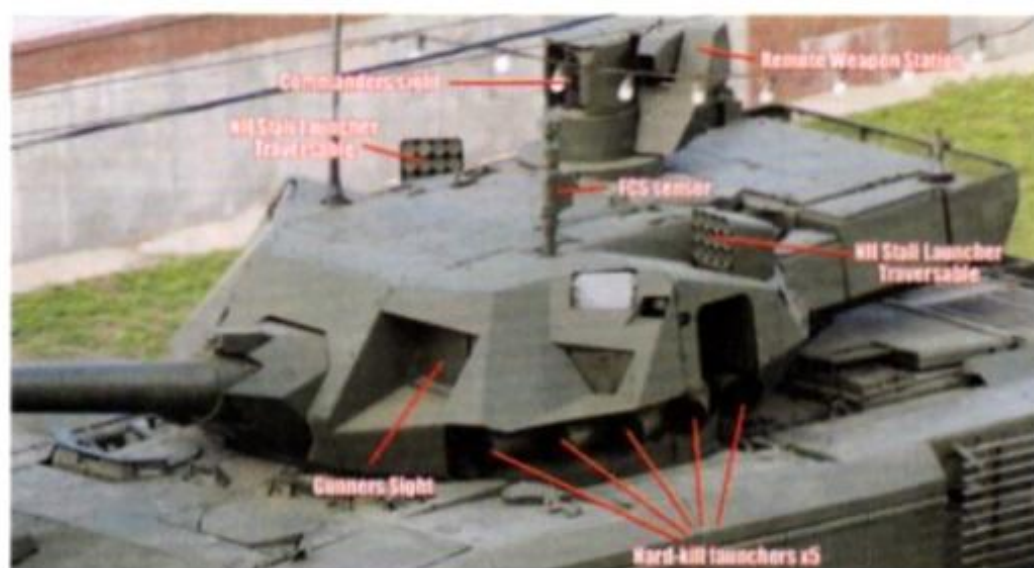
A sinistra: la torretta con indicati alcuni sistemi. A destra: vista frontale della stessa con ben evidenti le aperture dell'FCS del puntatore e quella di uno dei 2 comandi relativi alla componente hard kill dell'AFGHANIT.
