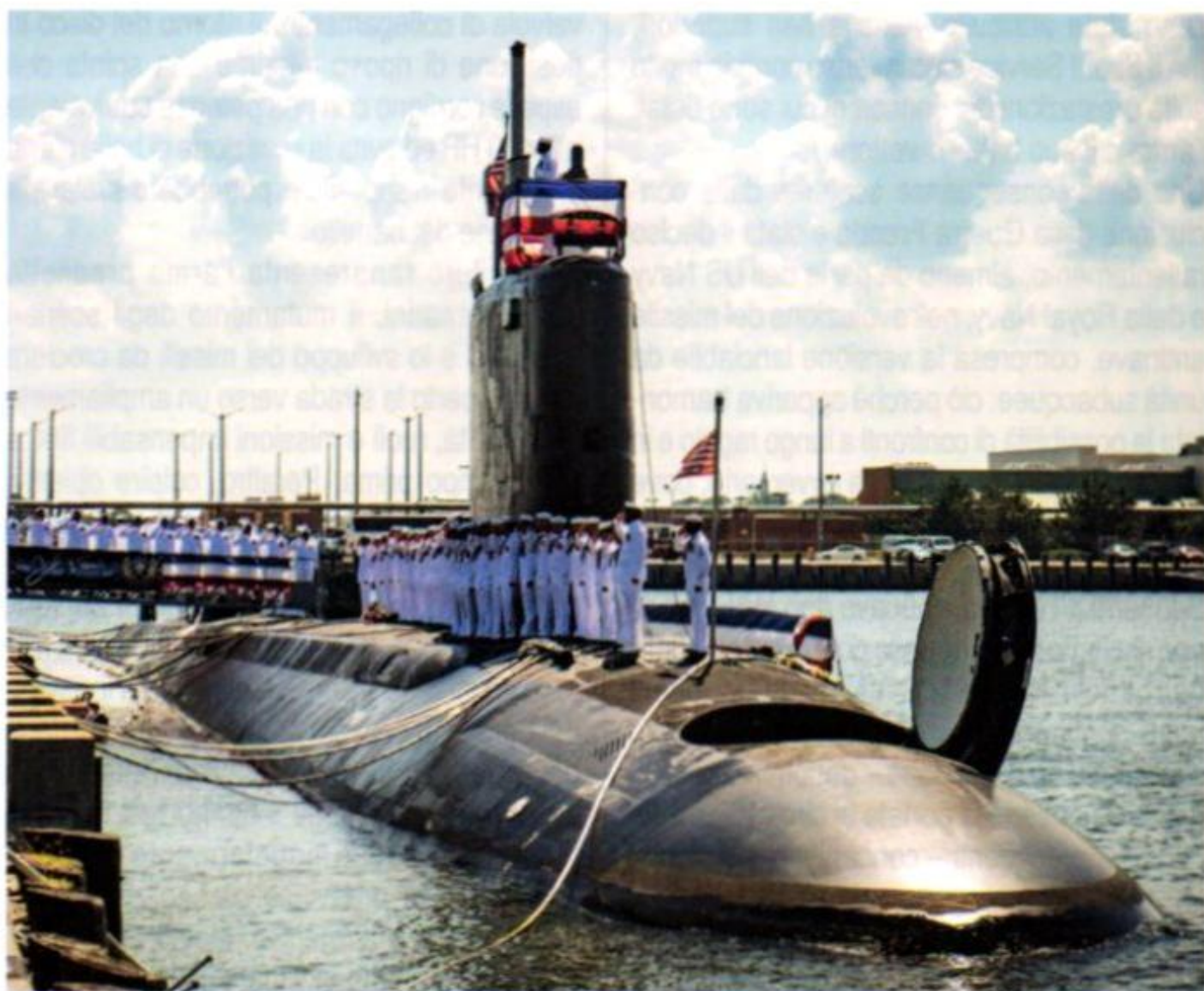
Il JOHN WARNER durante la cerimonia di consegna all'US Navy. Evidente, in primo piano, il grosso portellone di uno dei 2 "Virginia Payload Tube". (foto: USN)
