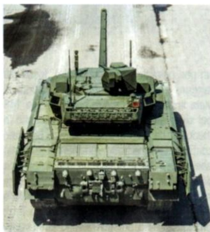
Sopra: una vista da dietro del T-14 che mette in evidenza la sezione occupata dal power pack e alcuni dettagli della torretta. Sotto: uno degli ARMATA fatti sfilare a Mosca il 9 maggio 2015.
