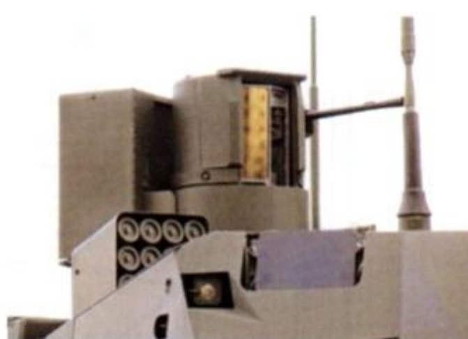
Lato destro della torretta mostrante alla sommità il sistema elettro-ottico del capocarro (vedi sotto) e una parte dei lanciatori e dei sensori del sistema di protezione AFGHANIT.
