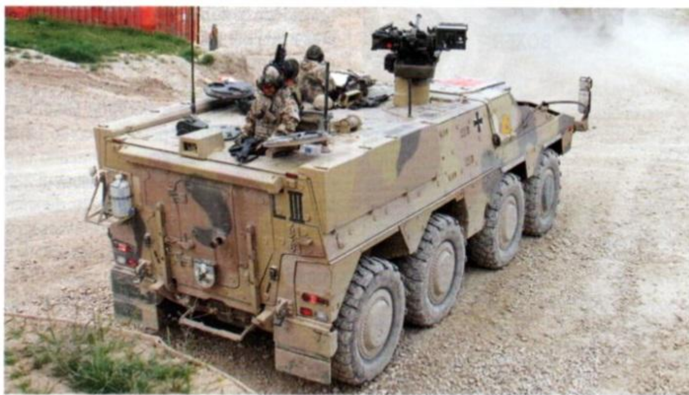
Un 8x8 BOXER nella versione A1 in Afghanistan (notare la torretta "rialzata" e le antenne del sistema di jamming). Tutti i mezzi tedeschi sono stati realizzati o sono stati aggiornati a questo standard. I BOXER nella versione APC ordinati dalla Germania saranno tutti allo standard A2. (foto: Bundesweher)
