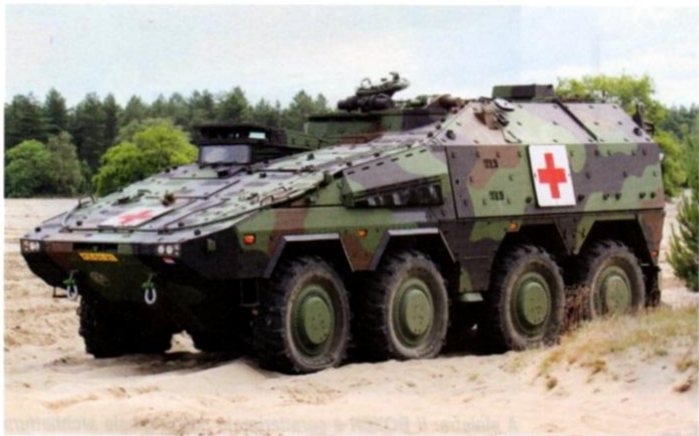
Un BOXER olandese in configurazione ambulanza. La variante dei Paesi Bassi è più che altro un veicolo portafertiti mentre quella in dotazione all'Esercito Tedesco è una vera ambulanza. (foto: Rheinmetall)
