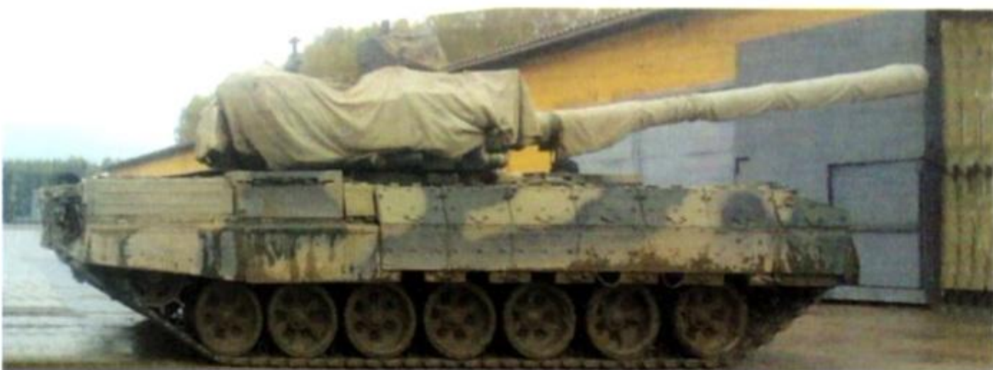
Sopra: un esemplare dell'Izdeliye 195 probabilmente impiegato per prove con il cannone a comando remoto da 152 mm. Sotto: il T-195 fotografato nel corso dei test.
