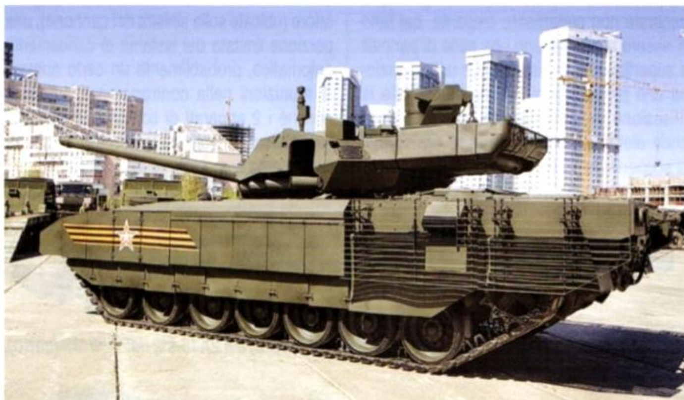
Sopra e sotto: le notevoli dimensioni dello scafo e la complessità delle superfici della torretta del T-14 risultano evidenti da queste 2 immagini.
