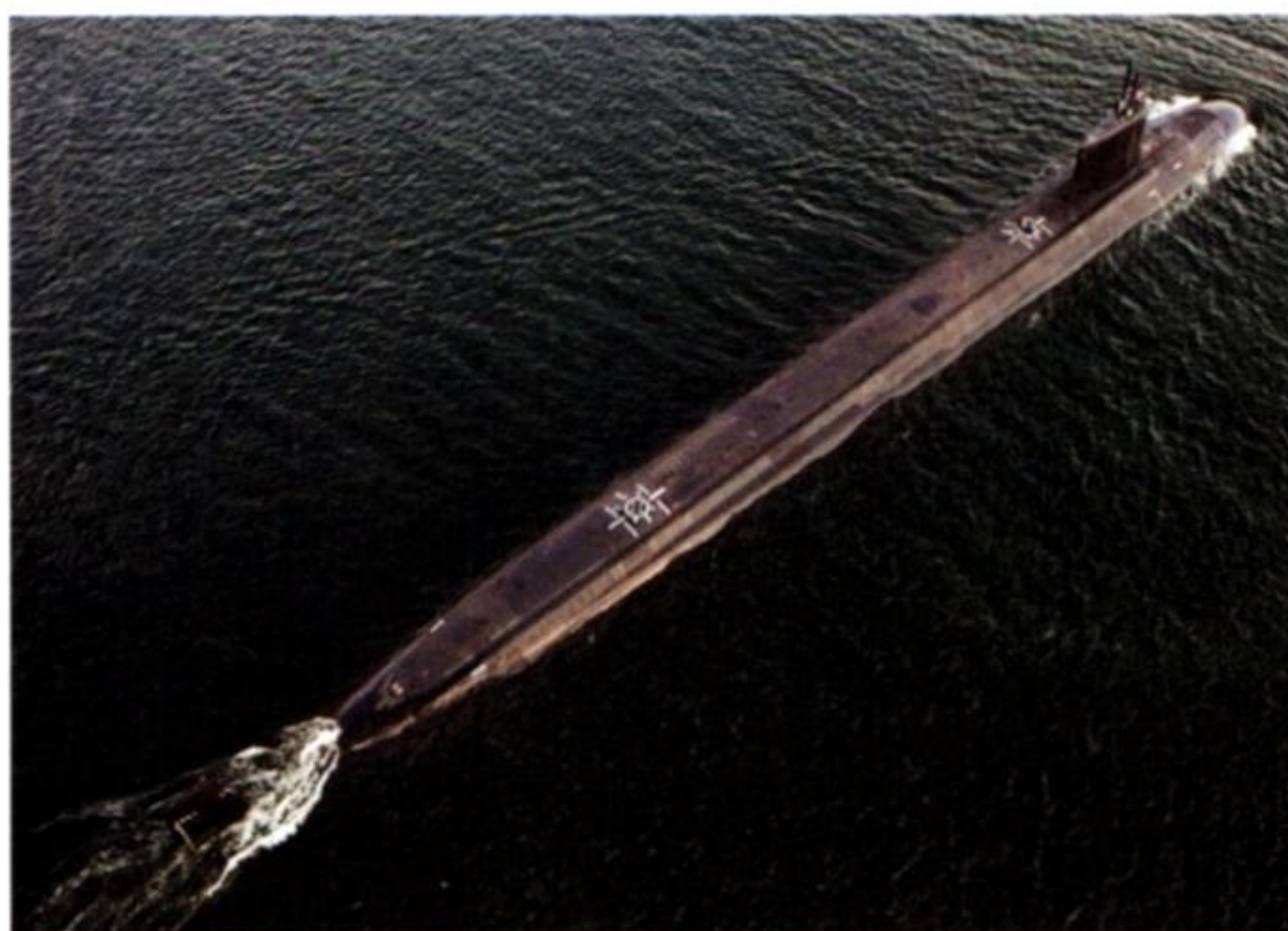
Una foto aerea, scattata in Oceano Atlantico nell'agosto 2014, del NORTH DAKOTA, primo esemplare del Block III: il ringrosso lungo la fiancata dritta è l'alloggiamento del sonar passivo rimorchiato "fat line". (foto: USN)
