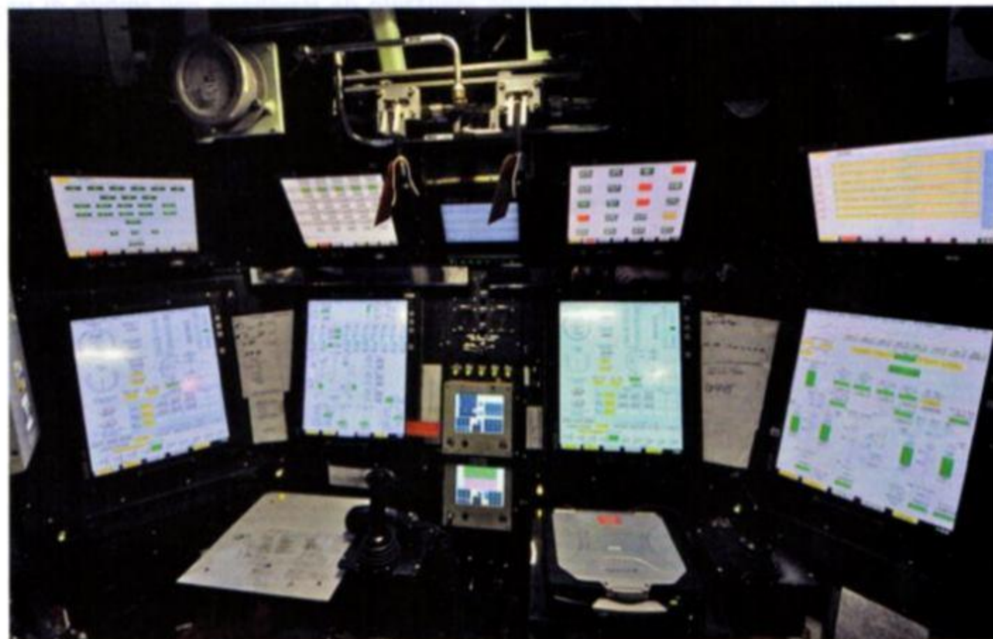
La postazione di governo e controllo piattaforma di un battello classe VIRGINIA. I 2 joystick servono per la manovra dei timoni: lo schermo a centro dritta serve per la navigazione ed è duplicato a sinistra, mentre lo schermo a centro-sinistra è impiegato per le operazioni di assetto e compenso dell'unità. (foto: USN)
