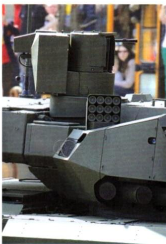
Sopra, a sinistra: un dettaglio di 3/4 dietro del lato destro della torretta che mostra una delle 4 antenne radar con a lato un sensore elettro-ottico e sopra uno dei 2 complessi brandeggiabili del sistema AFGHANIT. La stessa porzione di torretta è ritratta, di lato, sotto. Sopra, a destra, il power pack completo.
