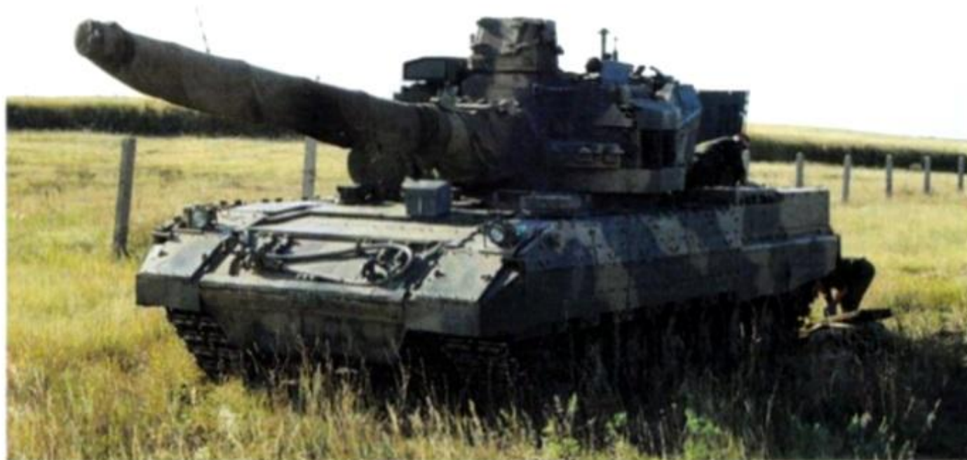
Sopra: ancora il T-195, qui durante le prove sul terreno. Sul lato sinistro della torretta si intravede la mitragliera 2A42 da 30 mm. Sotto: un mock-up di quello che avrebbe dovuto diventare il T-95, versione definitiva proposta dall'Uralvagonzavod.
