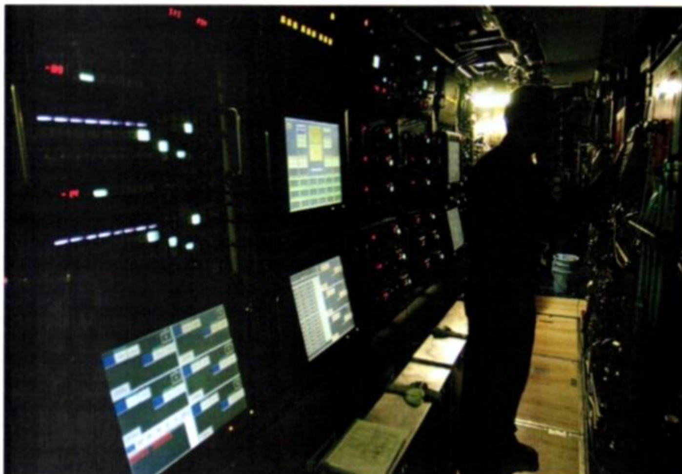
Il pannello di controllo per la preparazione e l'impiego delle armi (siluri, missili e/o mine) situato in camera lancio di un battello classe VIRGINIA e utilizzato in associazione alle consolle in camera manovra. (foto: USN)
