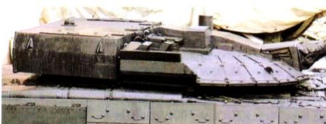
Sotto, a sinistra: il BLACK EAGLE venne sperimentato a partire dalla metà degli anni '90. Sotto a destra: la torretta del BLACK EAGLE caratterizzata dal sistema di caricamento automatico nella parte posteriore.
