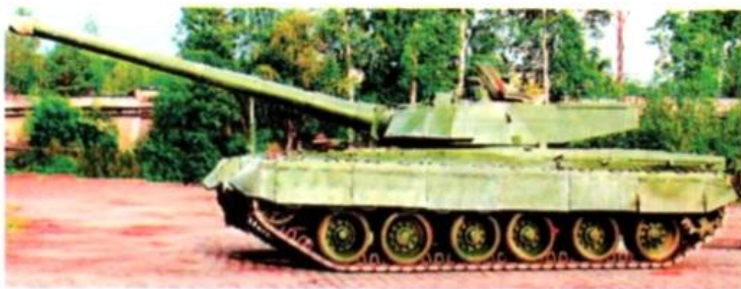
Sopra a sinistra: l'Izdeliye 292-1 con cannone da 152 mm su scafo T-80 allungato realizzato nel 1990. Sopra a destra: l'Izdeliye 640 CHYORNIY OREL (BLACK EAGLE) sviluppato dal "Bureau" LKZ e realizzato dall'Uralvagonzavod.
