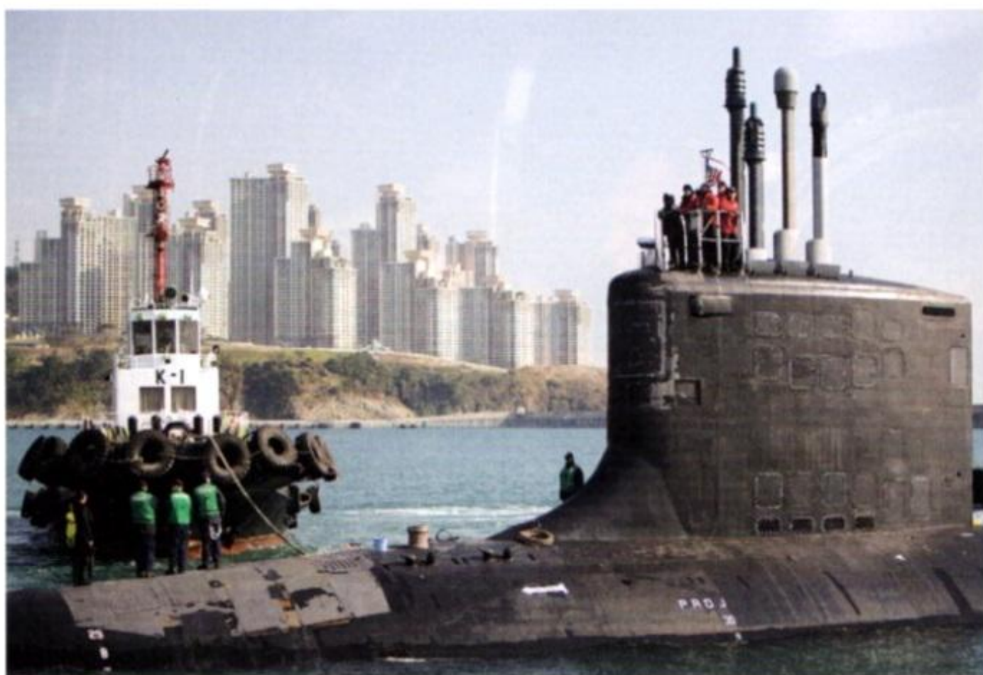
Il sottomarino HAWAII all'ingresso nel porto sudcoreano di Busan per una visita di routine: ben visibile il ringrosso idrodinamico della falsatorre, nella cui area frontale superiore si distingue anche il pannello di un sensore sonar attivo. (foto: USN)
