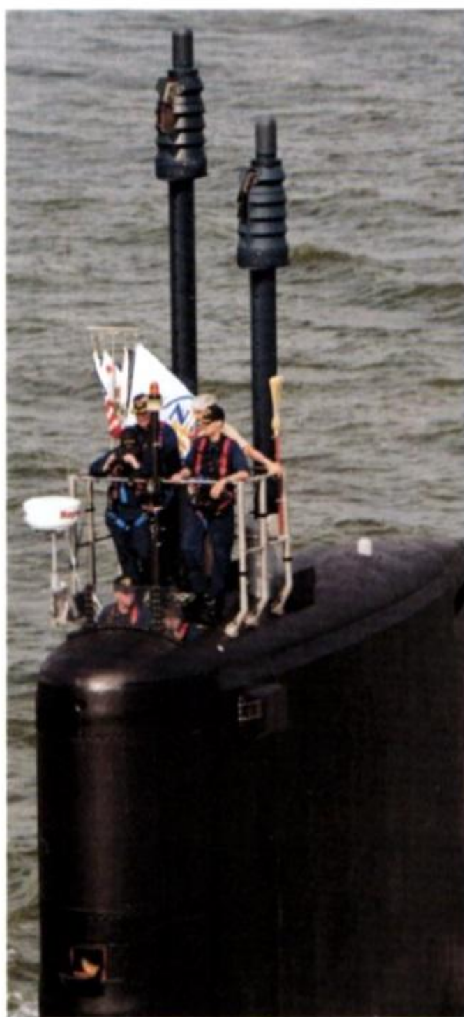
Un primo piano della falsatorre del CALIFORNIA al rientro dalle prove in mare; la scopa indica che i test si sono completati con successo, probabilmente compresi quelli dei 2 alberi fotonici sollevati. (foto: HII).
