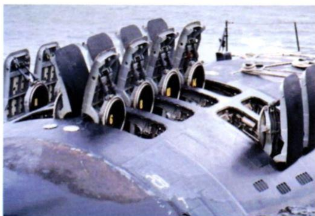
Primo piano dei 12 tubi verticali lancia-missili da crociera, con i portelloni aperti, a bordo di un VIRGINIA Block II; la numerazione segue quella dei tubi lanciasiluri all'interno del battello. (foto: USN)
