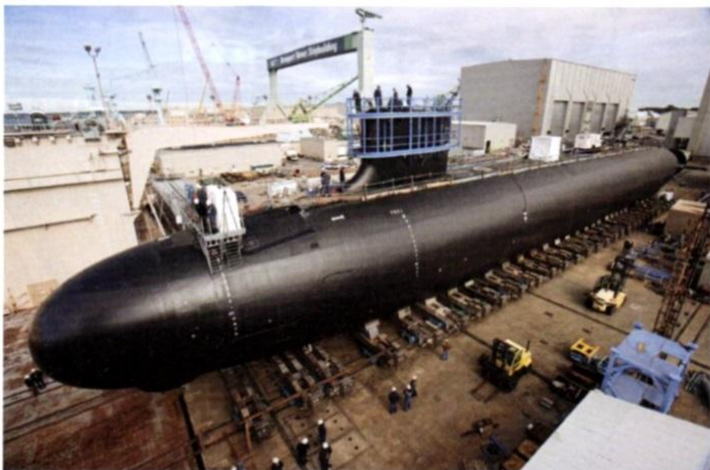
Il MINNESOTA durante l'allestimento con le attività concentrate sulla falsatorre e in corrispondenza dei tubi di lancio verticali. (foto: HII)
