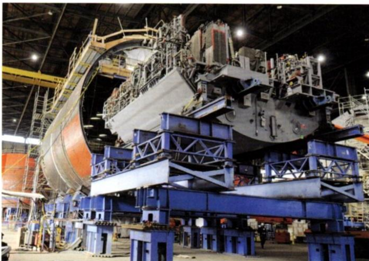
Un Modular Isolated Deck Section (MIDS) preallestito viene inserito all'interno della zona inferiore di una sezione di scafo di un VIRGINIA. (foto: HII)
